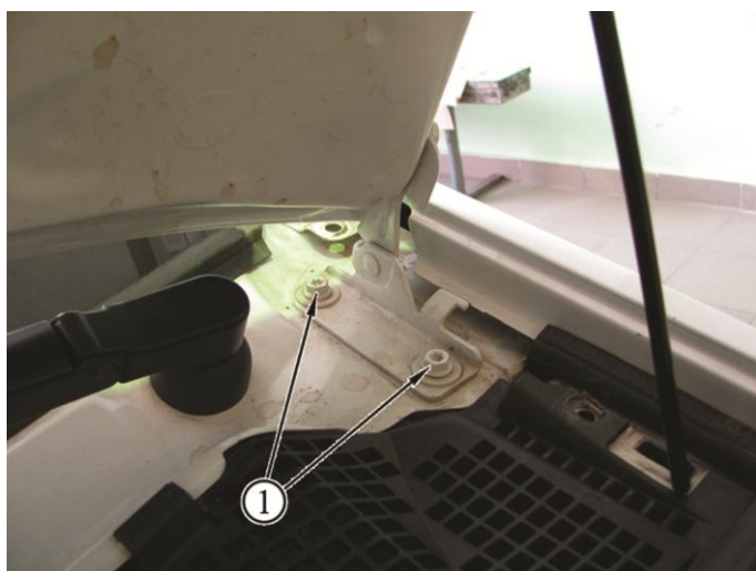
Рисунок 6-4 – Снятие петель капота:
