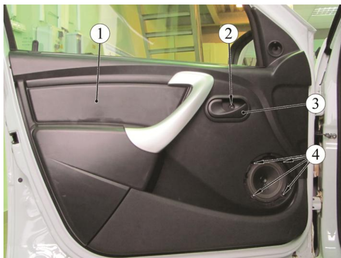
Рисунок 4-1 – Разборка передней двери:
