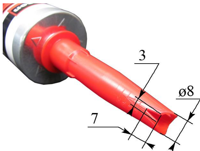
Рисунок 16-2 – Схема обрезки нако- нечника тубы
