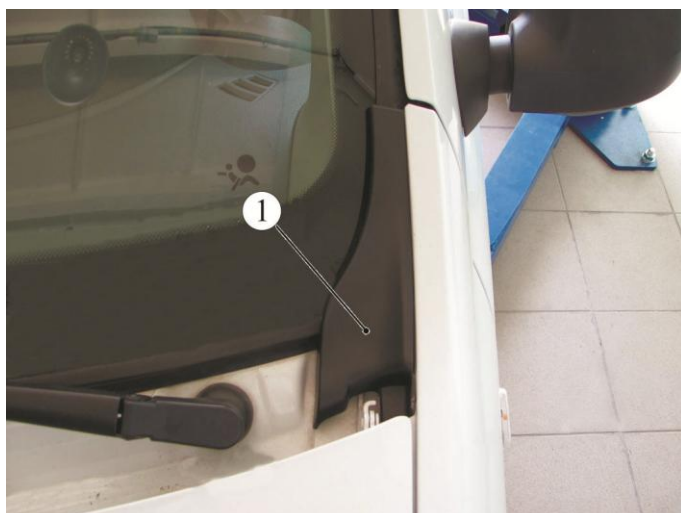
Рисунок 8-3 – Снятие облицовки переднего крыла:
