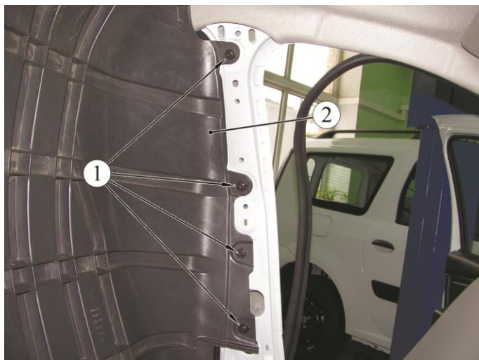
Рисунок 19-3 – Крепление перегородки к стойке:
