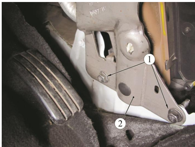
Рисунок 13-1 – Нижнее крепление усилителя поперечины панели приборов:
