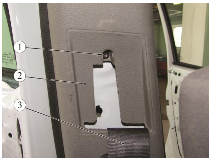
Рисунок 10-3 – крепление обивки центральной стойки:
