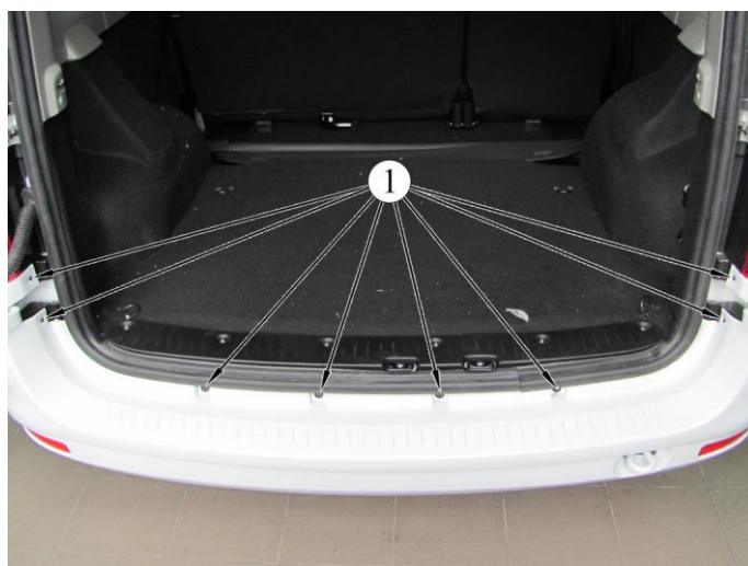
Рисунок 3-4 – Верхнее крепление бампера:
