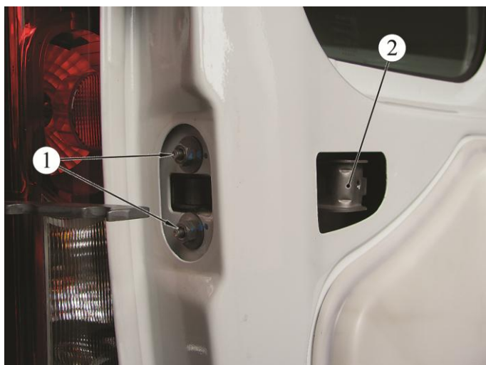
Рисунок 7-7 – Крепление замка ограничителя погрузочной двери:
