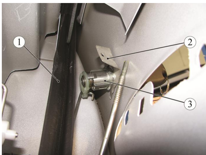
Рисунок 4-7 – Крепление личинки замка передней двери:
