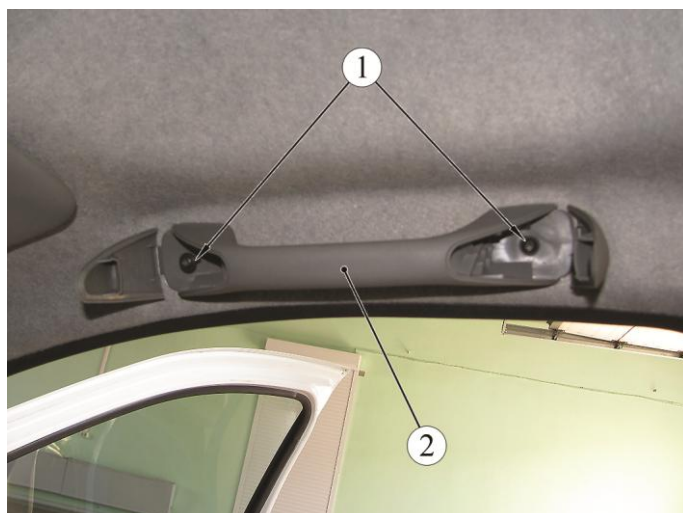
Рисунок 11-2 – Крепление поручней:
