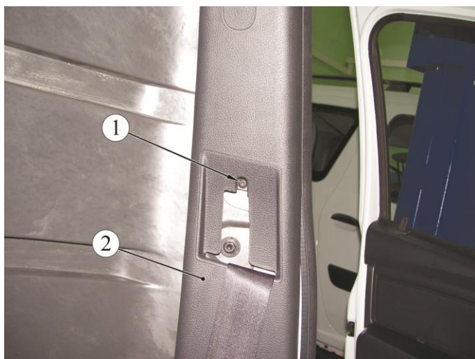
Рисунок 19-2 – Крепление облицовки центральной стойки:
