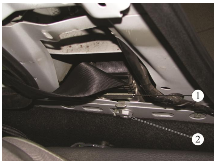
Рисунок 10-4 – Крепление инерционной катушки переднего ремня безопасности:
