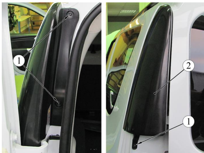
Рисунок 7-8 – Крепление верхней накладки заднего фонаря:
