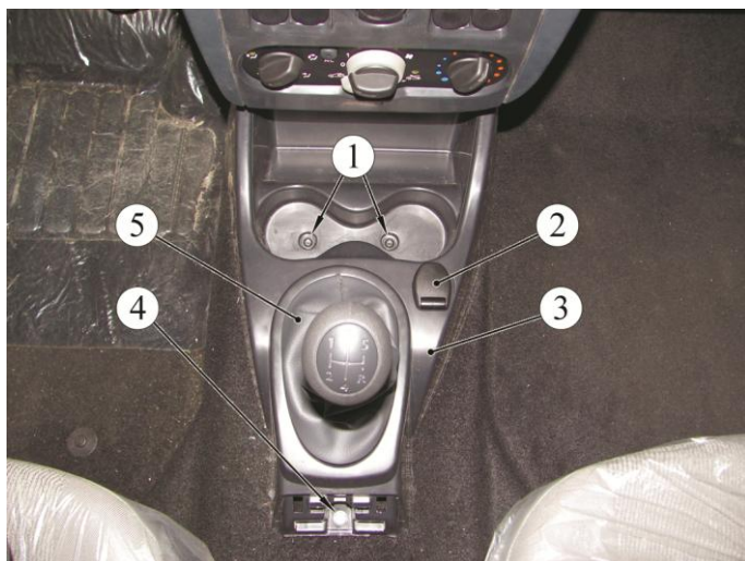
Рисунок 12-4 – Крепление передней части облицовки туннеля пола:
