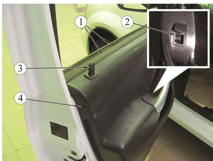
Рисунок 4-3 – Крепление обивки с торца:
