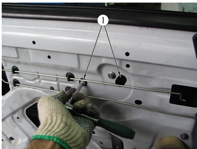
Рисунок 5-2 – Крепление стекла задней двери к ползуну стеклоподъемника:
