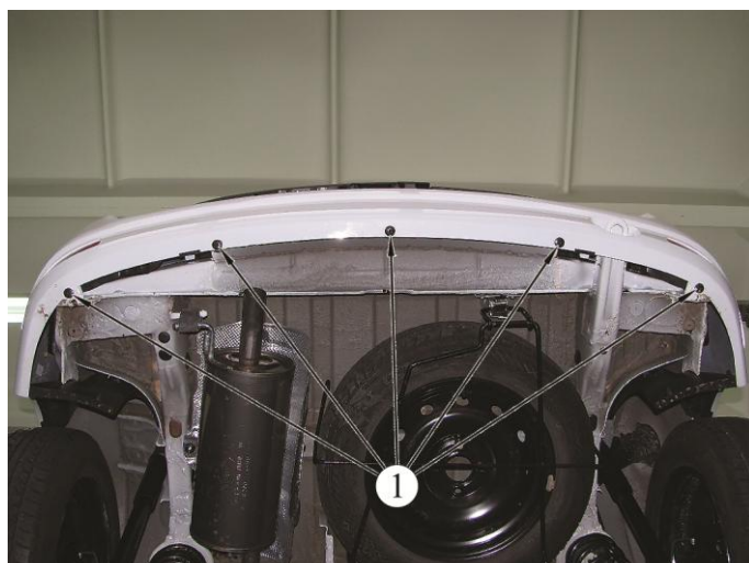
Рисунок 3-2– Нижнее крепление бампера:
