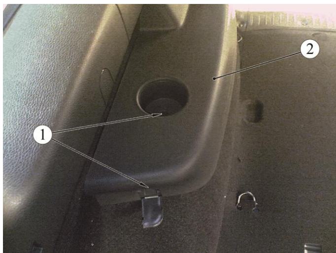
Рисунок 18-1 – Снятие подлокотника третьего ряда сидений:
