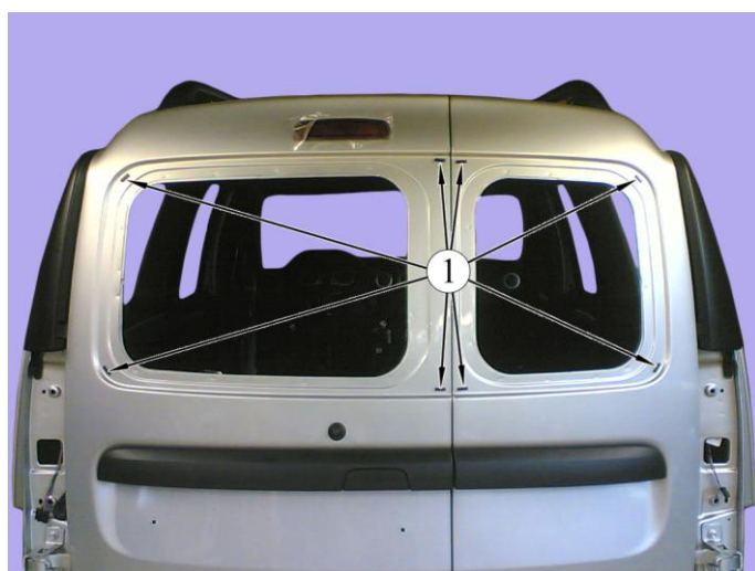
Рисунок 16-10 – Схема наклейки дистанционных прокладок на проемы окон погрузочных дверей:
