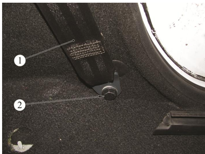
Рисунок 10-6 – Нижнее крепление заднего ремня безопасности:
