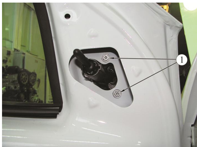
Рисунок 4-10 – Крепление зеркала заднего вида:
