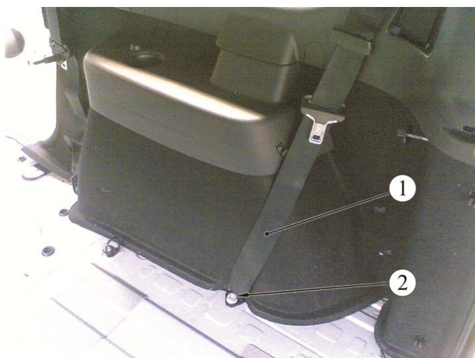
Рисунок 10-13 – Нижнее крепление ремня безопасности третьего ряда сидений:
