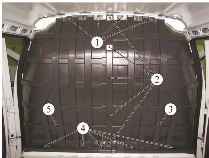
Рисунок 19-4 – Крепление перегородки:
