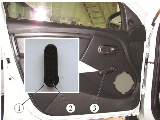
Рисунок 4-2 – Снятие ручки стеклоподъемника:
