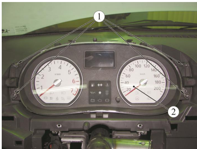
Рисунок 12-7 – Крепление комбинации приборов:
