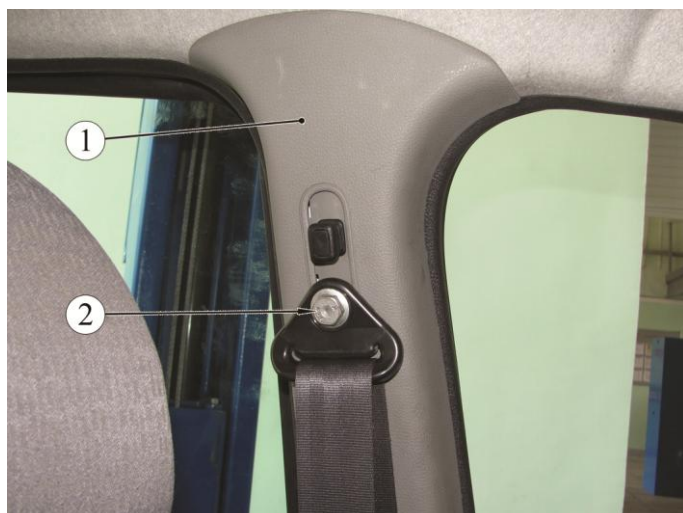
Рисунок 10-2 – Верхнее крепление переднего ремня безопасности:
