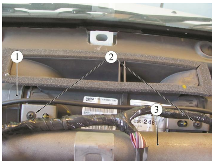
Рисунок 13-4 – Крепление воздухо-распределительного блока к поперечине панели приборов:
